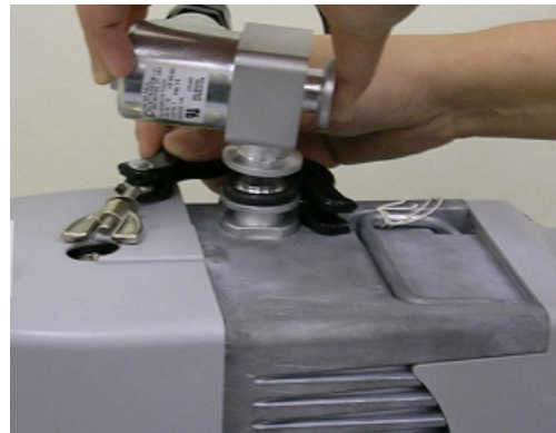
그림 9 IDP-3 펌프에 흡입 밸브 장착
